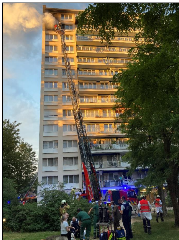
Image 5 L'échelle pivotante exécute une attaque extérieure sur la chambre à coucher en feu (Photo : Marc Baert).
