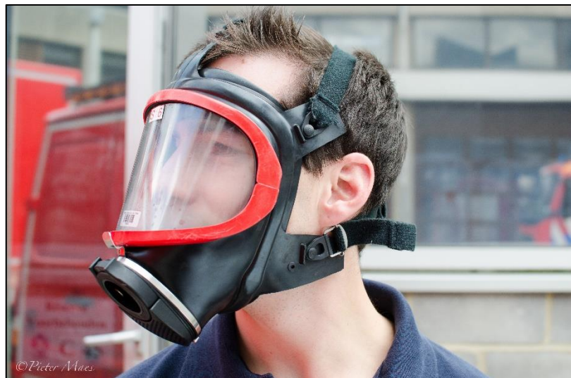
figuur 4 Een reddingsmasker dat op het hoofd van een slachtoffer kan geplaatst worden. Dit masker moet voorzien worden van een longenautomaat. Die heeft best een extra lange middendrukslang zodat het slachtoffer en de redder vlot naast elkaar kunnen wandelen. (Foto: Pieter Maes)
