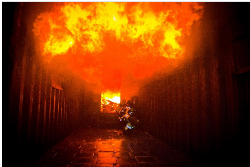
figure 6 Un pompier participe à un entraînement pour étudier l'inflammation de gaz d'incendie. Lorsqu'il ouvre la porte à l'arrière, la couche de fumée au plafond s'enflamme à cause des flammes qui sortent. Le pompier est soumis à une chaleur rayonnante très élevée pendant cet entraînement. (Photo : Stijn Hermans)
