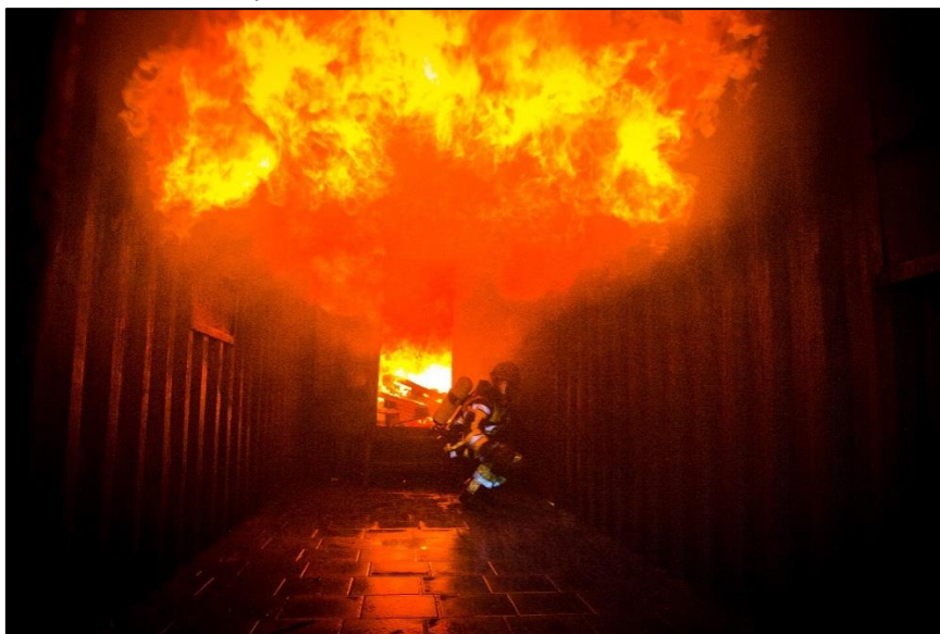
Figura6 Un bombero involucrado en un ejercicio de entrenamiento para estudiar las igniciones de los gases del incendio. Cuando abre la puerta en la parte trasera, la capa de humo en el techo se enciende debido a las llamas que salen. El bombero está sujeto a un calor radiante muy alto durante este entrenamiento. (Photo: StijnHermans)
