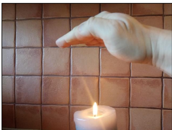
Figura1. Sobre la vela se puede sentir la parte convectiva del calor producido por la llama. (Photo: Szymon Kokot-Góra)
