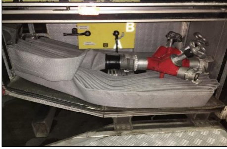
图 7 折叠放置的 70mm 水带和分水器直接相连，是一项重大的战术改进，可以在不改变水泵的情况下轻松完成连接。（照片：Steve Viaene）
