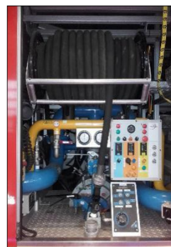
图 8 在水罐车尾部装配的低压软管卷
