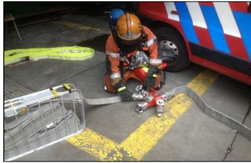
图 6 在供水系统中的不同部位分别采用单卷式水带和层叠水带。70 毫米水带连接到三分水器。图中显示了将折叠水带连接到分水器。在灭火点时，黄色单卷式水带将连接到层叠水带中。（照片：卡雷尔兰伯特）
