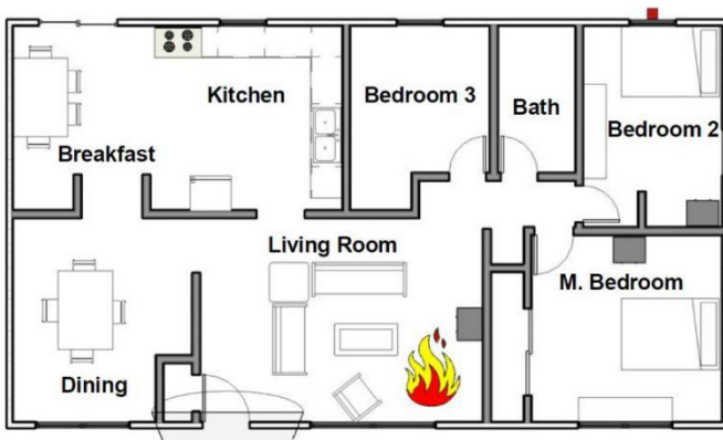
图3 具有典型性的房间部局，有许多独立的房间，每个房间的表面面积是有限的。（图：UL FSRI）
