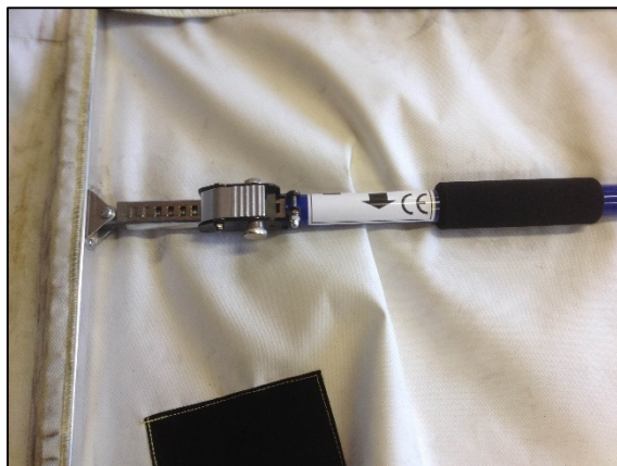
Figura 4 Posicionamiento del mecanismo de cierre del bloqueador de humo. Presionando la pestaña de la barra esta puede ser ajustada. Posteriormente, girando la barra en la dirección de la flecha se añade tensión que mantendrá el dispositivo. (Photo: Karel Lambert)
