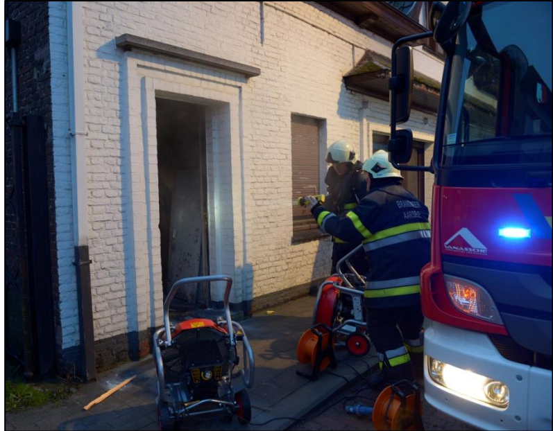
Şekil 4 İki pozitif basınçlı fanın V formunda konumlandırılması. (Fotoğraf: Frank Meurisse)
