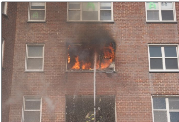
Bild 5 Einsatz der "floor below nozzle" um unter 'wind driven conditions' Wasser in ein brennendes Appartement zu spritzen (Foto: NIST)
