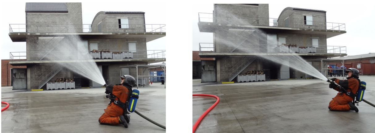
Figuur 1.3 & 1.4 Op de linker foto wordt een short pulse gegeven. De hoek tussen de straalpijp en de vloer bedraagt ca. 45°. De kegelhoek bedraagt 40-60°. Op de rechter foto wordt een long pulse gegeven. De hoek tussen de straalpijp en de vloer bedraagt ca. 30°. De kegelhoek bedraagt ca. 30°. (Foto's: Geert Vandamme)
