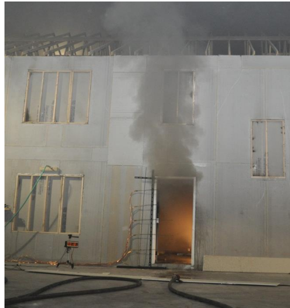
Fig 2.1 I fumi fuoriescono dalla parte superiore della porta mentre il resto del porta viene utilizzata per la fornitura di fresco aria. Questa aria fresca permetterà una rapida crescita del fuoco. (Foto: Steve Kerber - Underwriters Laboratori)
