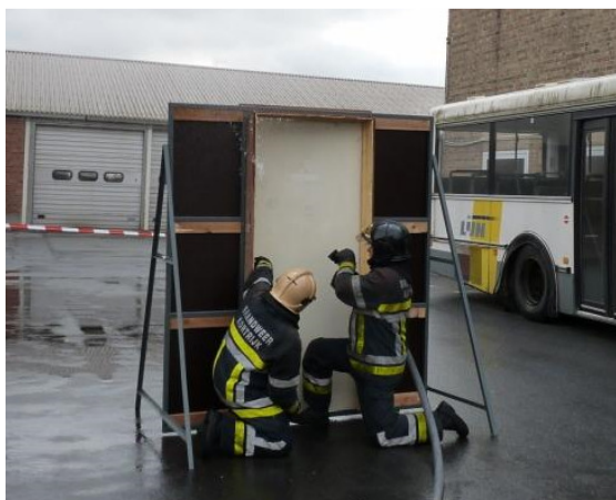
Fig. 1.1 Posición del equipo de ataque en una "puerta de empujar". (Photo: Ronny Bundervoet )
