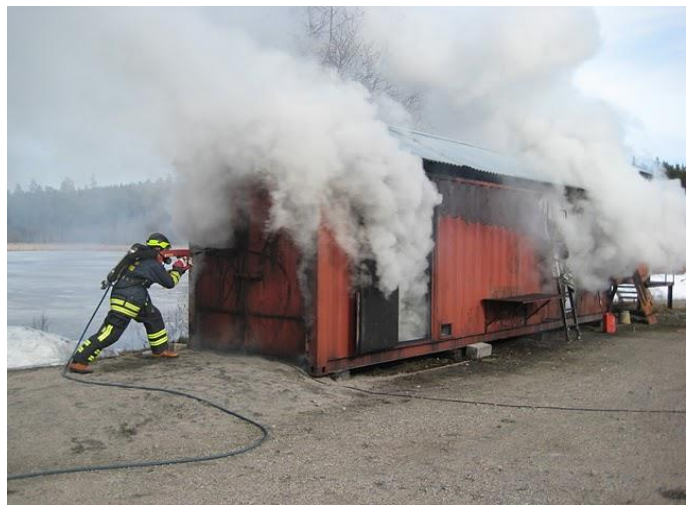
図 12.4 訓練現場で活躍する Cobra。消火ガスは完全に不活性化され、冷却される。(写真提供: Willem Nater)
