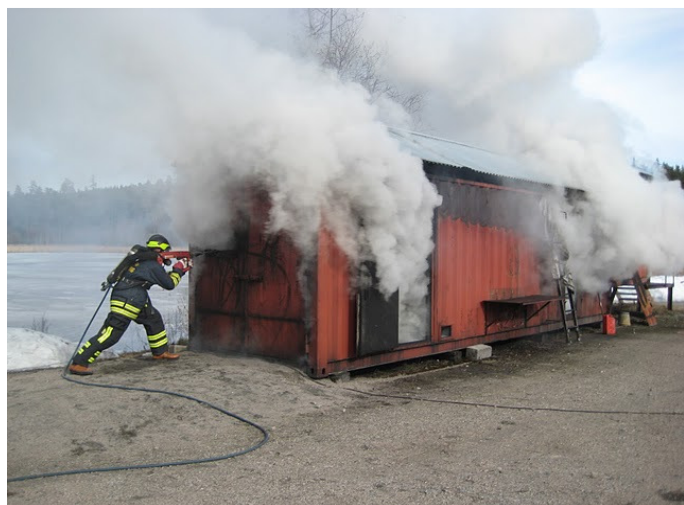
Fig 12.4 De cobra in actie op een oefenobject. De rookgassen worden helemaal geïnertiseerd en gekoeld. (Foto: Willem Nater)
