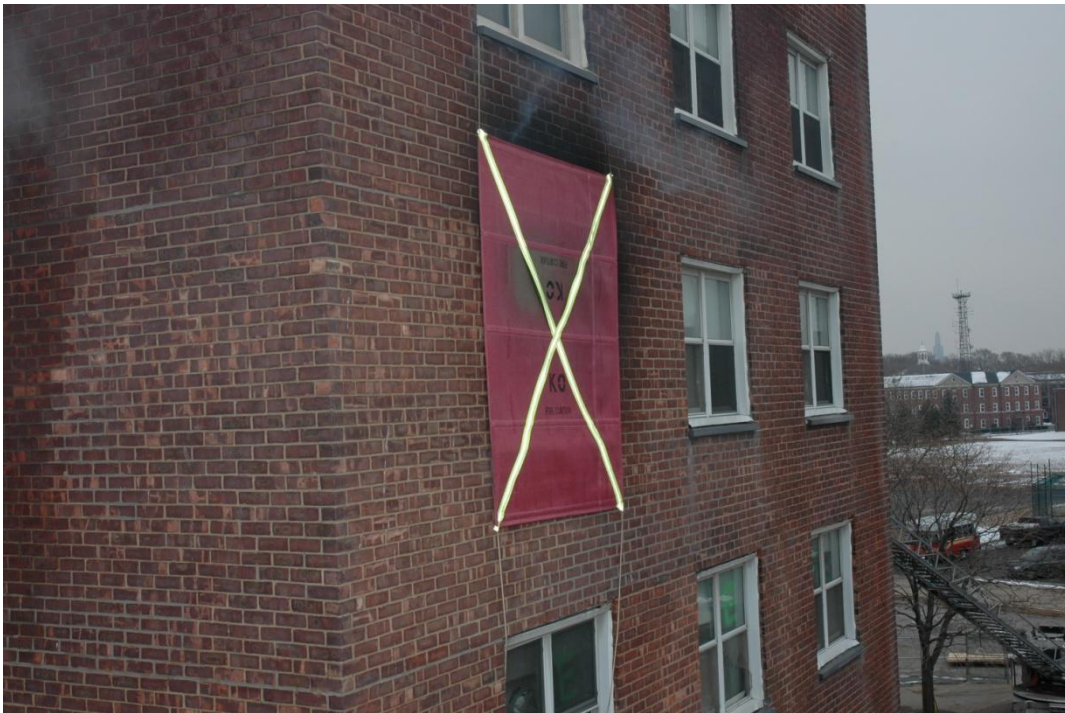
Εικόνα 5 Χρήση συσκευής ελέγχου ανέμου(εικόνα: NIST)
