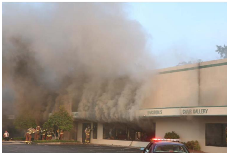
Fig 5.3 Il fumo inizia a scorrere attraverso le finestre rotte mentre un massiccio flusso di aria fresca entra nell'edificio. (Picture: Charleston post)
