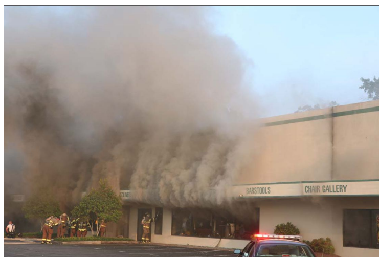
Bild 5.3 Nach dem Einschlagen der Fenster entsteht augenblicklich ein starker Ausstrom von heißen Brandgasen und gleichzeitig werden Massen Frischluft in den Raum eingesaugt (Foto: Alexander Fox)
