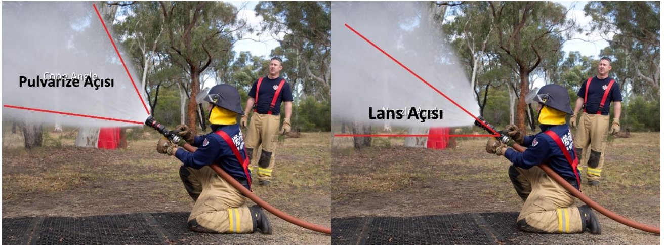
Resim 2. Pulvarize açısı ve lans açısı
