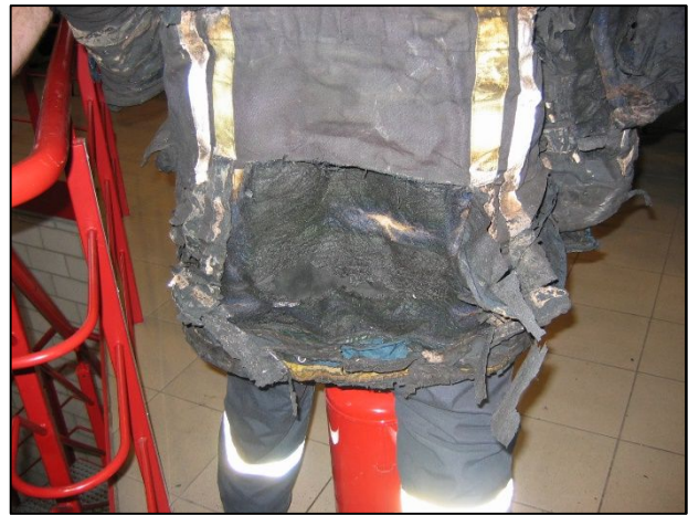
Bild 2 Das ist die Brandjacke von einem der Feuerwehrleute. Unschwer zu erkennen, die schweren Schäden verursacht durch das Feuer. (Foto: Feuerwehr Westhoek – Posten Diksmuide)
