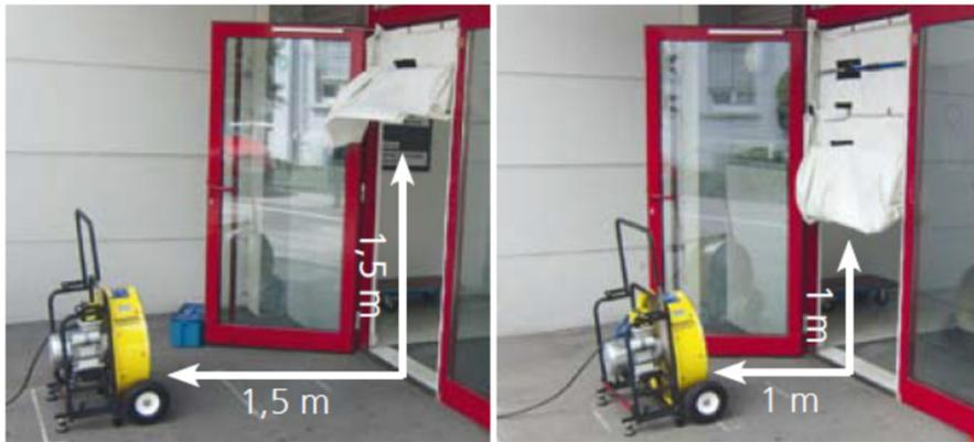
links: Bei einer lichten Höhe der Zuluftöffnung von rund 1,5 Meter sollte der Abstand des Belüftungsgerätes ebenfalls 1,5 Meter betragen. rechts: Bei einer geringeren Höhe ist auch der Abstand zwischen der Zuluftöffnung und dem Belüftungsgerät entsprechend zu verringern.
