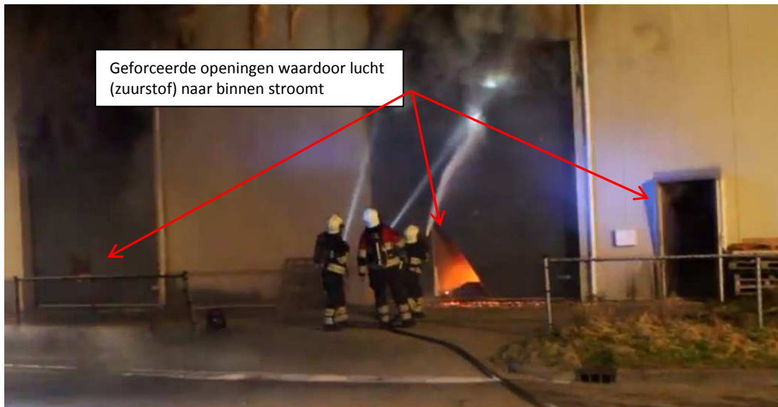
Afbeelding 3 1:20 uur, brand in ventilatiebeheerste fase, lucht stroomt door openingen naar binnen (YouTube)
