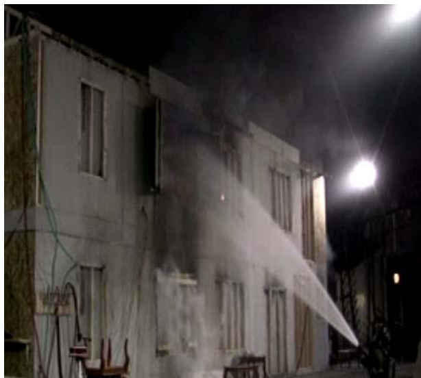
Figuur 4.36: Nevelstraal sluit stromingspad af
