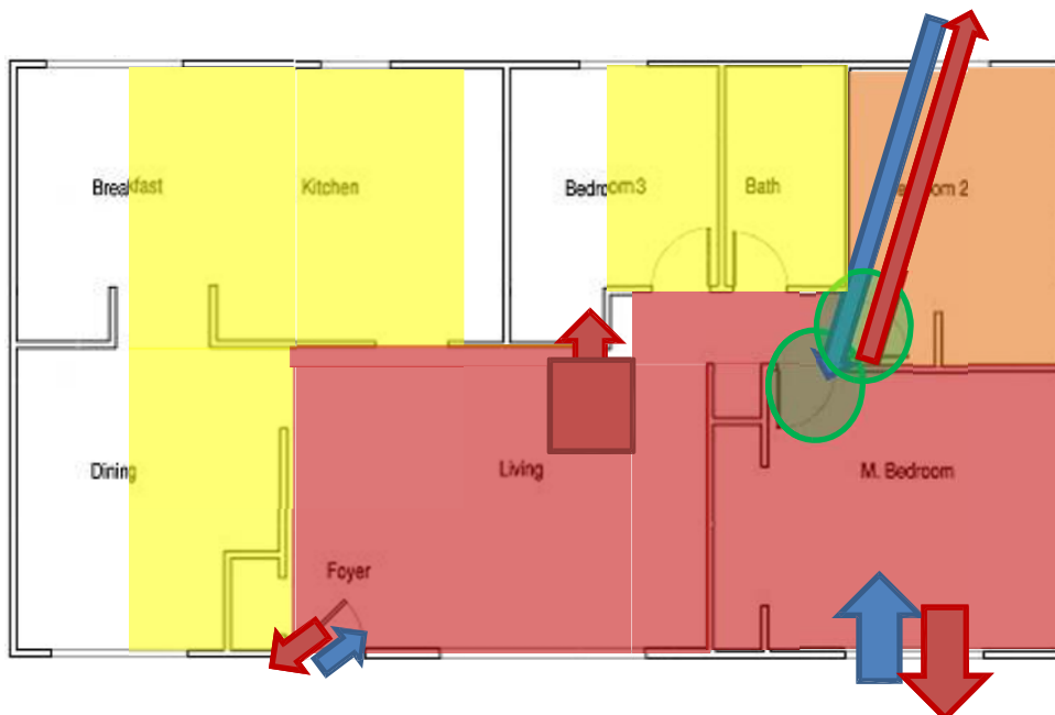
Figuur 4.19: Stromingspaden nadat het raam van de slaapkamer aan de achterzijde is geopend
