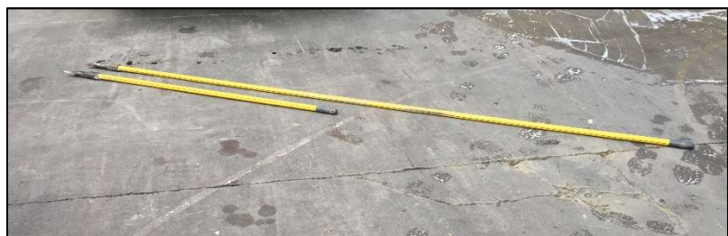
figuur 11 De twee "démolisseurs" waarover brandweer Brussel beschikt. Deze laten toe om boven het hoofd van de brandweertuig afbraakwerken te doen. Tijdens de interventie in de Noord-Zuidverbinding werden ze gebruikt om te verifiëren of er nog stukken cementpleister konden naar beneden vallen.
