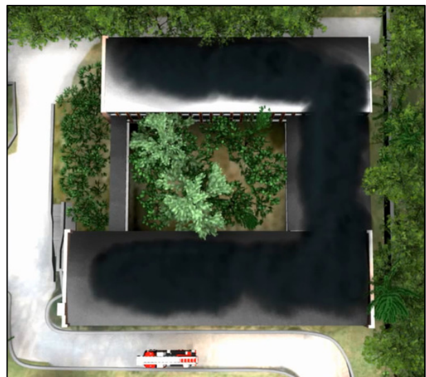
Figuur 7 De rookopbouw start door de brand in gebouw A (tekening linksboven). De rookconcentratie neemt toe evenals de rooktemperatuur. De rook wordt in het vals plafond van gebouw C geduwd. Daar zal de rook ook opstapelen (tekening rechtsboven). Na verloop van tijd wordt ook de valse ruimte onder het dak van gebouw B gevuld met rook (tekening linksonder). De ruimtes bevatten nu een mengsel van rookgassen en de oorspronkelijke lucht. (Figuur: [3])
