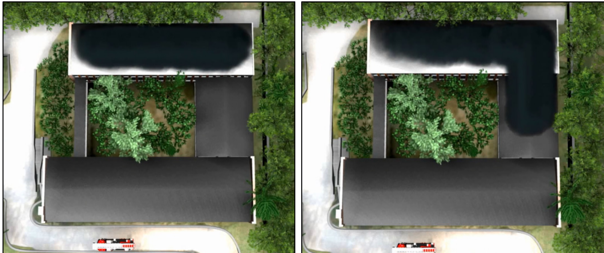
Figuur 7 De rookopbouw start door de brand in gebouw A (tekening linksboven). De rookconcentratie neemt toe evenals de rooktemperatuur. De rook wordt in het vals plafond van gebouw C geduwd. Daar zal de rook ook opstapelen (tekening rechtsboven). Na verloop van tijd wordt ook de valse ruimte onder het dak van gebouw B gevuld met rook (tekening linksonder). De ruimtes bevatten nu een mengsel van rookgassen en de oorspronkelijke lucht. (Figuur: [3])
